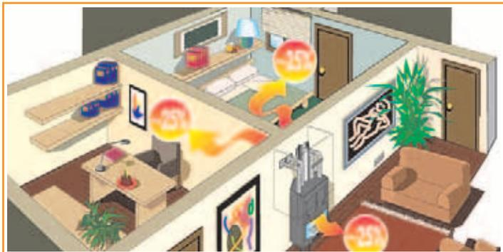
Uscite per la canalizzazione dell'aria calda.
